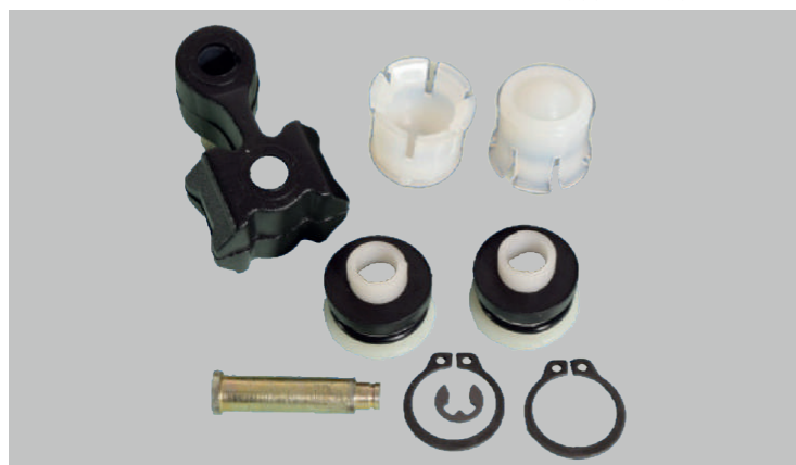
4-02-19 Kit de Bujes Control Cambios Corsa
